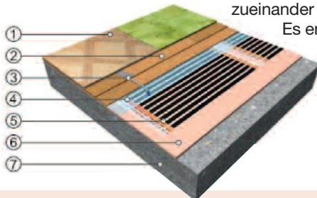
Es entsteht eine starre, kompakte Konstruktion mit der Stärke von insgesamt 7mm, auf die dann PVC-Beläge oder Teppiche schwimmend verlegt oder geklebt werden können.
