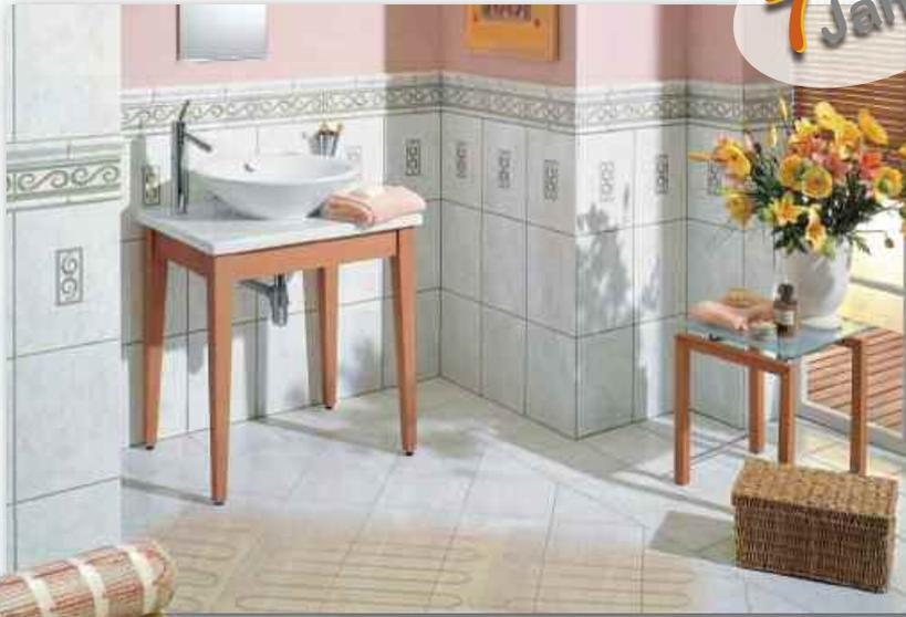
Das vitalheizung®-Mattensystem besteht aus einem Heizkabel, welches auf einem Gewebe aus Glasfasern befestigt ist (Heizmatte). Die Heizmatten werden unmittelbar unter den Fliesen in einer dünnen Schicht aus elastischem Kleber verlegt. Dadurch erwärmt sich die Oberfläche der Fliesen sehr rasch. Die ausgereifte Temperaturregelung reagiert rasch und präzise.
